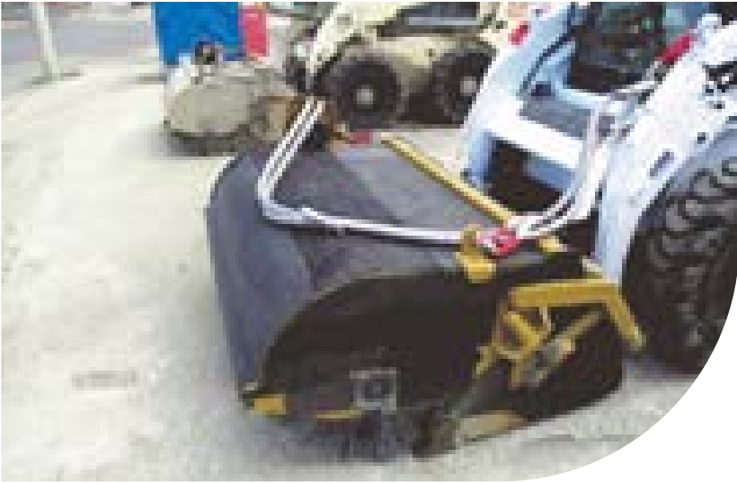
動力機具加裝隔音棉，可阻隔噪音並減少對施工人員因噪音造成的傷害
